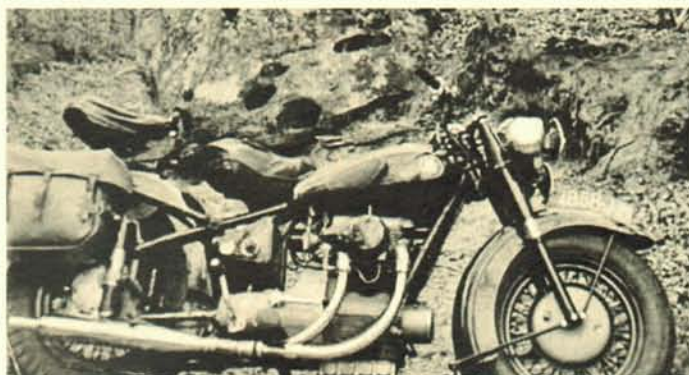
La 500 Sunbeam sur laquelle on voit bien la grosse section des pneus et, sur le côté, le commutateur utilisé pour alimenter la prise de courant.
